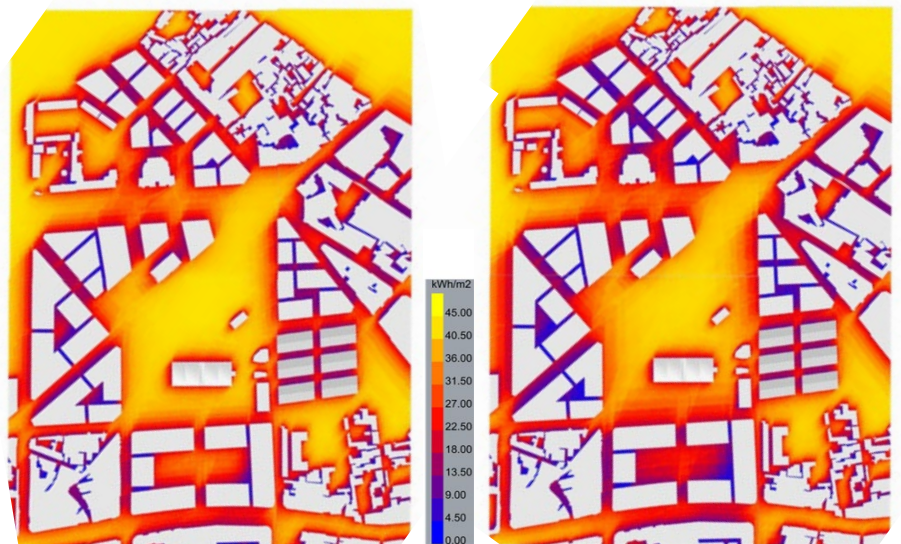
Cartographie d'exposition au rayonnement solaire lors de la semaine la plus chaude (kWh/m 2 )
